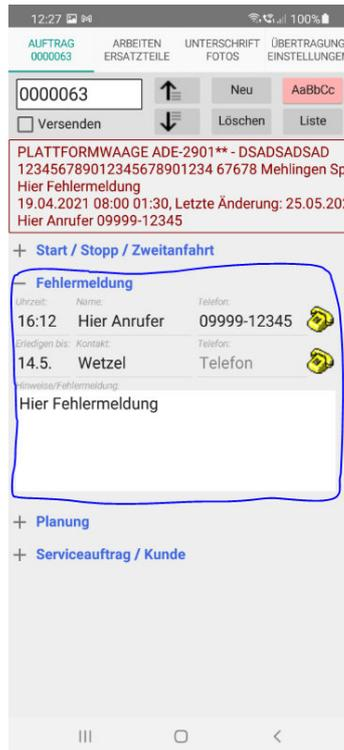
WinDelta® Service-App, 'Auftrag': Expander '+ Fehlermeldung' geöffnet
